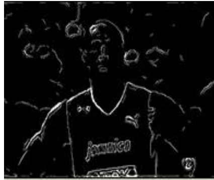
Figure 3 Edge detection using Canny edge detector
